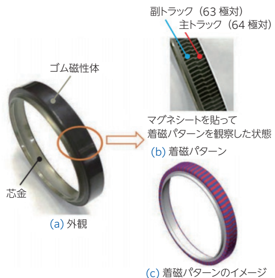
図 4 複列磁気リング：ラジアル着磁タイプ 3)
