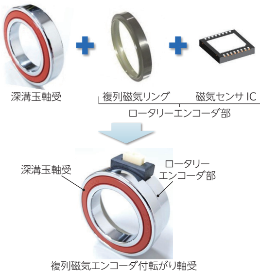
図 2 複列磁気エンコーダ付転がり軸受の主要部品構成
