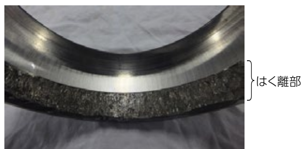
図9 300時間後の外輪軌道面 Outer ring raceway after 300 hours
