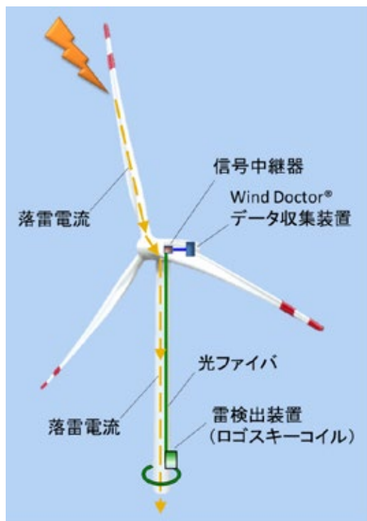
図8 雷検知システムとの連動 CMS with Lightning detection system
