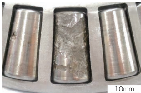
図13 継続試験ではく離が進展したころ Test bearing after the continuous test
