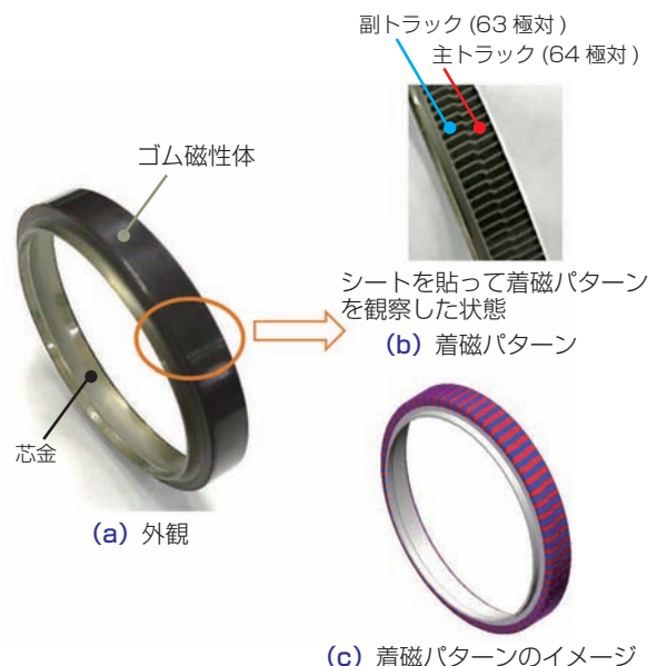
図3 複列磁気リング：ラジアル着磁タイプ Multi Track Magnetic Ring-radial type
