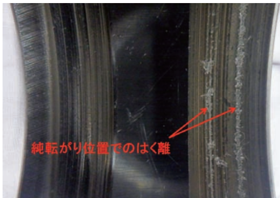
図6 純転がり位置でののはく離 Flaking on non-slip line
