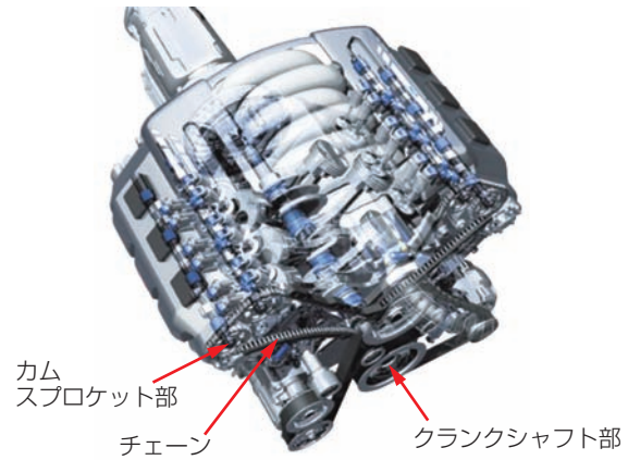
図18 OHCエンジンのカムシャフト駆動構造 Camshaft driven structure of OHC engine
