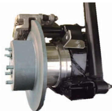
(a) HUB モジュール搭載 Setting of HUB module
