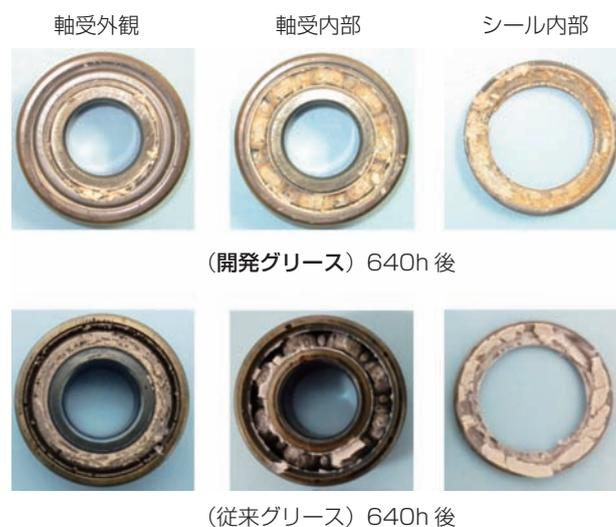
図13 試験後の軸受内部
