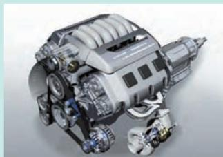
自動車用電装補機部品の電動化が進むにつれ、車両の電力消費は増加する。このため、オルタネータの発電能力を高めることから周辺環境がより高温となり、オルタネータ用の軸受も高温に対応する必要がある。
