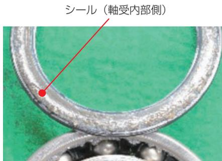
図3 破損直前のグリース状況
