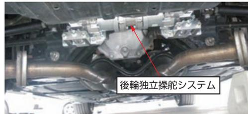
**図 10** 搭載写真 (車両後方から撮影)
