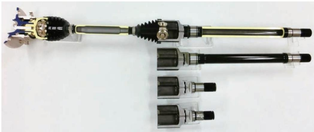
図2 ADSモジュール構造（写真）
