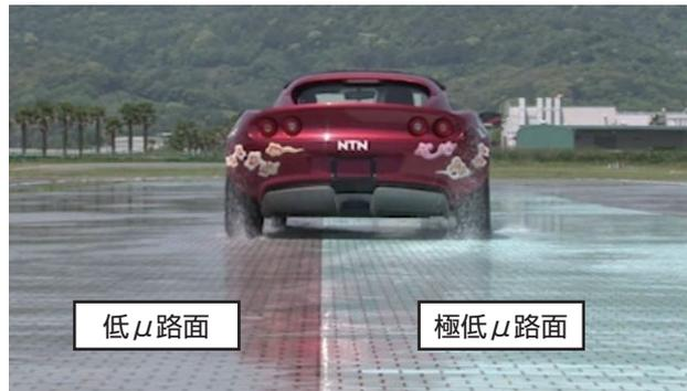
図14 スプリット $\mu$ 路走行試験
