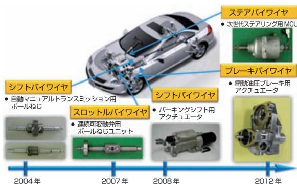
図3 バイワイヤによる電動化への対応
