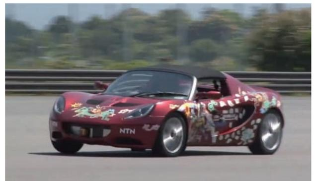
図11 正弦波操舵走行試験
