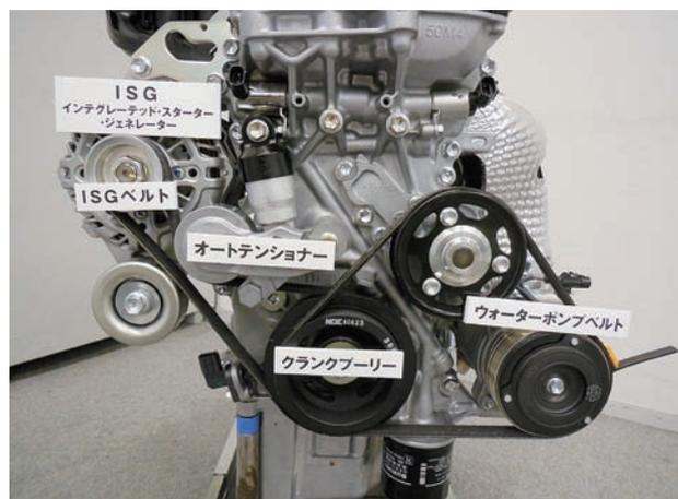
図2 ISGを搭載したエンジンの例<sup>2)</sup>
