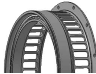
図9 一体化された軸受モデル Unitized model of a bearing
