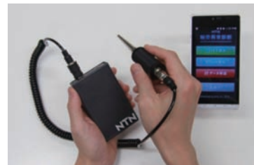
図8 ハンディ型異常検知装置 Handy type failure detection device
