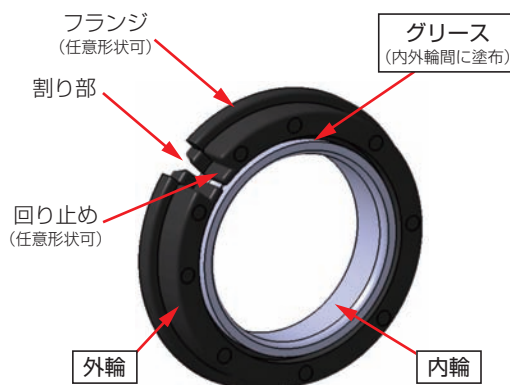
図3 高負荷すべり軸受ユニットの構造 Structure of high load sliding bearing unit
