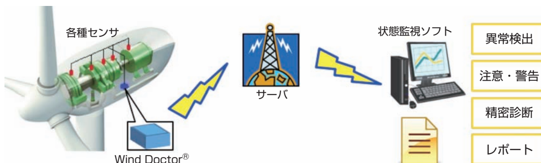
図2 風力発電用CMSの仕組み Structure of CMS for wind turbines
