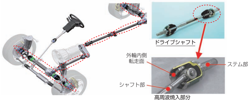
図1 自動車に搭載する高周波焼入部品例（ドライブシャフト） Example of induction hardening parts (Drive shaft)
