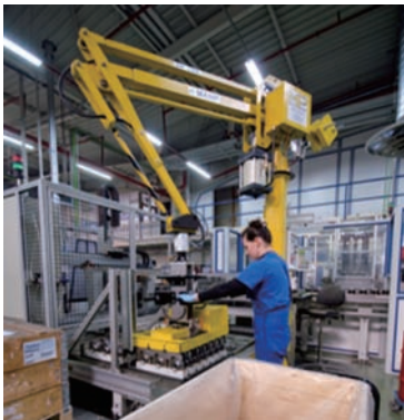
人の動きに合わせて補強するロボット例 Example of robot to follow man's movements while multiplying its strength
