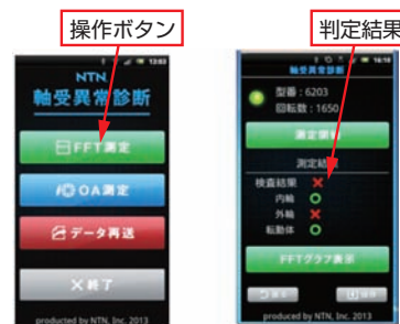
図10 ハンディ型の操作画面と判定画面例 Operation screen and judgment screen
