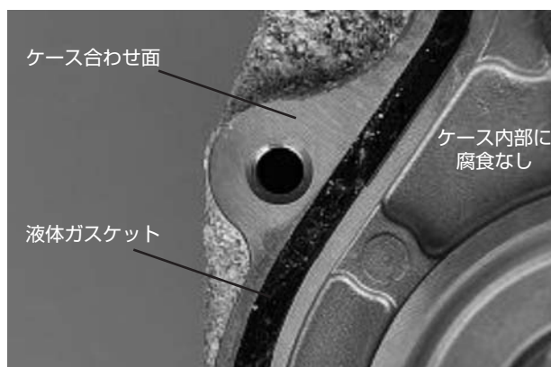
図6 塩水噴霧試験後のケース合わせ部 Aluminum case after cyclic corrosion test
