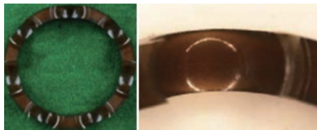
破損・クラックなどの異常は認められない
