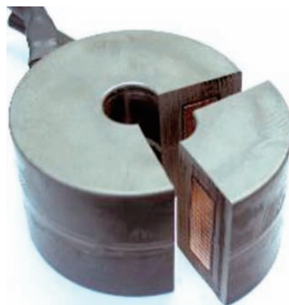
図5 MRI電源用チョークコイル Choke coil for MRI power supply
