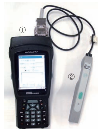
図8 読み書き装置（PDAタイプ） Reader and Writer (PDA Type)
