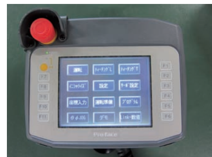
図5 専用ティーチングコンソール The dedicated teaching console
