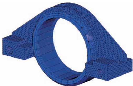
図6 自動調心ころ軸受用軸受箱解析モデル Analytical model of housing for spherical roller bearing
