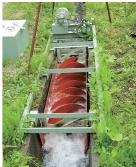
図6 農業用水路を利用したらせん水車発電システム Power generation system using axial type turbine set in a small irrigation canal
