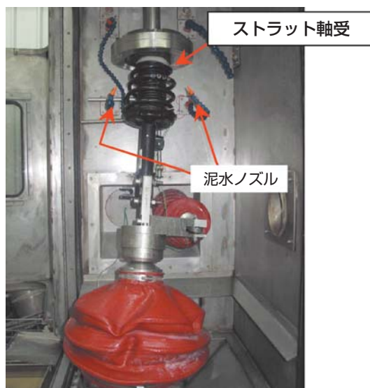
図7 マクファーソンサスペンションでの泥水試験機 Sealing test with McPherson suspension
