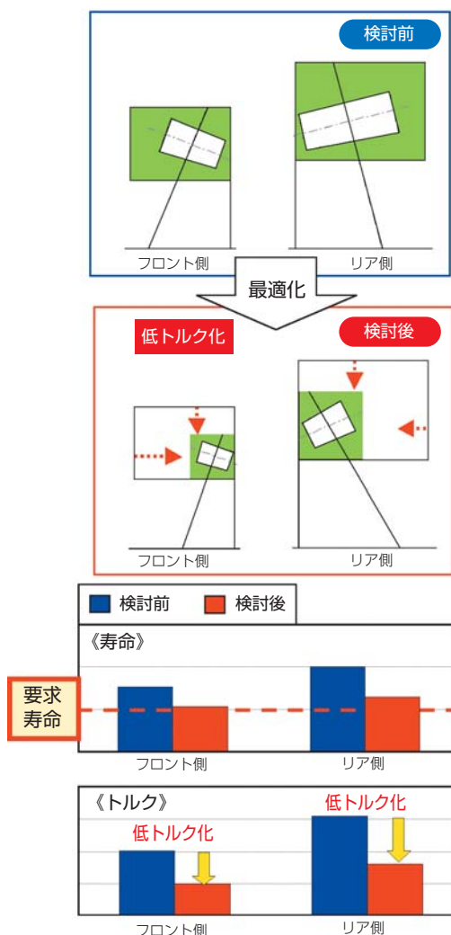
図4 ピニオンシャフト支持軸受の最適化のイメージ Optimization image of pinion shaft support bearings
