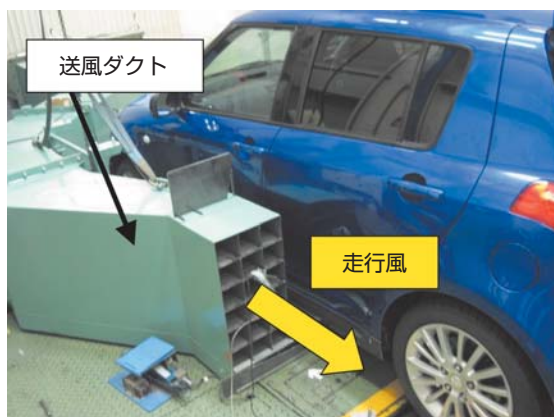
図11 シャシダイナモ実車試験 Vehicle test on chassis dynamometer
