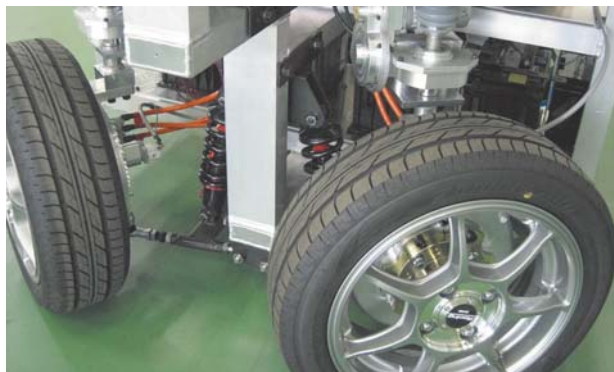
図7 その場回転モードの転舵状態 Steering state in Pivot Turn mode
