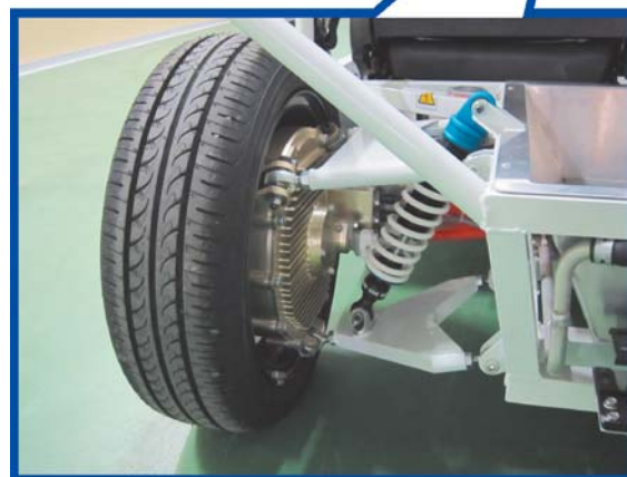
図4 試験車両（上）およびユニット搭載状態（下） Test EV (upper) and mounted In-wheel Motor (lower)
