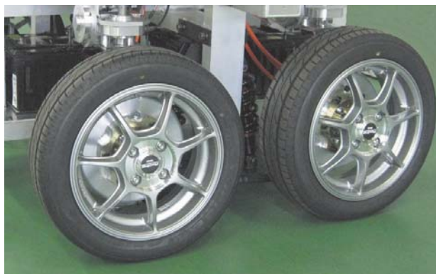
図8 横方向移動モードの転舵状態 Steering state in Lateral Move mode
