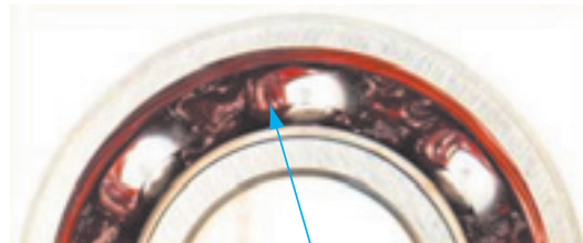
図11 ポケット幅狭保持器（図8）のグリース付着状態 Grease deposition of ball bearing with cage of narrow pocket width (Fig. 8)
