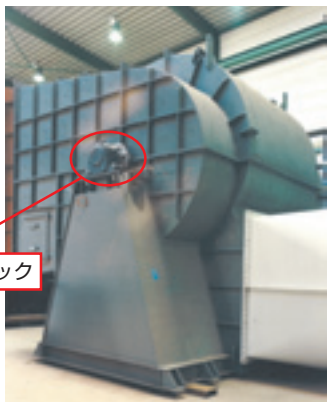
図1 油潤滑プランマブロックの適用例（大型送風機） Application example of oil-lubricated plummer block (large size air blower)
