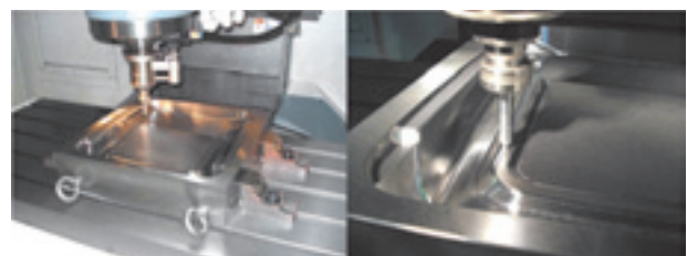
図5 吸引工具による金型の仕上げ加工 Mold finish machining by suction tool
