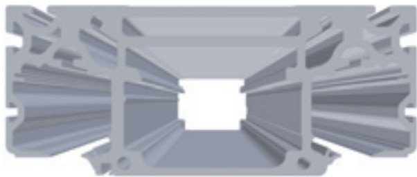
図11 押し成型で製作したフレームの断面構造 Cross section structure of flame
