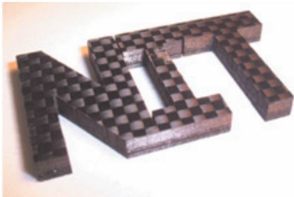
図8 ワイヤ放電加工によるC-FRPのトリミング C-FRP trimming by wire-electrical discharge machine
