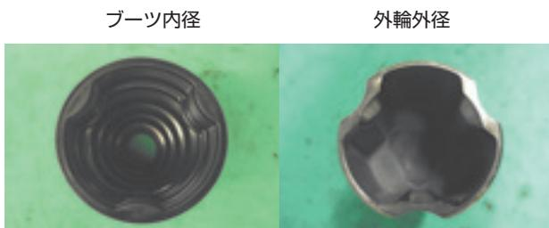
図6 TJ型CVJ用ブーツ内径形状と外輪外径形状
