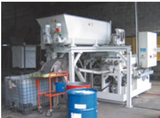
図15 研削スラッジ固形化装置
