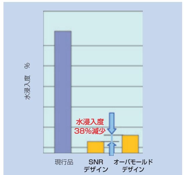
図24 泥水試験結果
