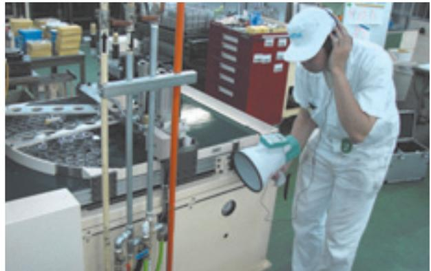
図9 エア漏れ検出器による測定
