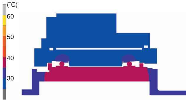
図6 間座幅を大きくした場合の解析結果 Analysis result with wide spacer
