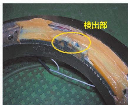
(b) 試験初期における検出部へのグリースの付着状態 (図10に示すT 2 酸化鉄混入前の状態) Condition of the attached grease to detection point
