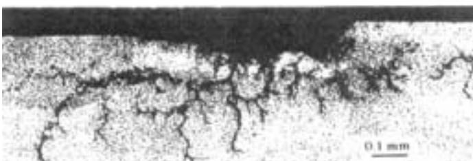
図6 オルタネータ用軸受外輪の周方向断面き裂<sup>12)</sup>
