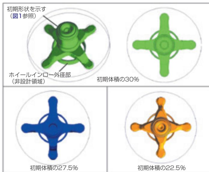
図2 トポロジー最適化解析結果
