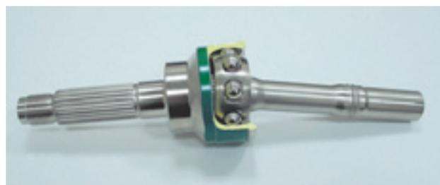
写真2 アイドリング振動低減CVJ (撮影のため、部分的に切断しています)
