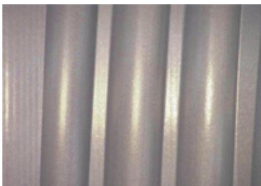
写真8 研削レスナットの転走面
