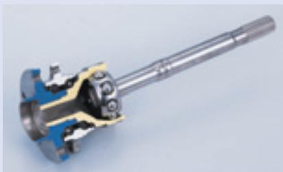
開発期間の短縮，試験回数の削減にはCAEの活用が有効であり，そのためには解析精度の向上が重要である．次世代商品として等速ジョイントとハブベアリングを一体化した4世代ハブジョイントの締結手法として使われている拡径加締め加工について，有限要素法による拡径加締め解析手法の開発を行ったので，その内容について紹介する．
