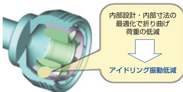
図5 アイドリング振動低減の手法
