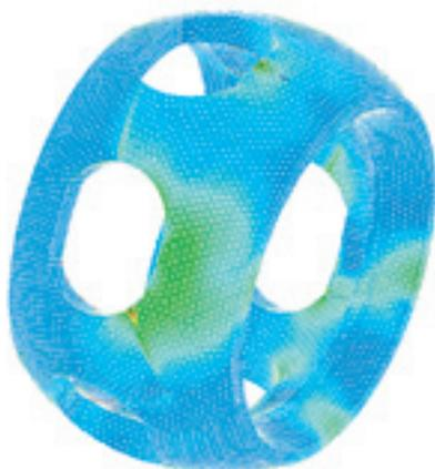
図7 TUJケージFEM応力解析例
