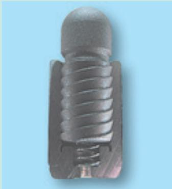
従来の油圧タイプに置き換わる製品として、この歯ねじを利用した機械式のバルブクリアランス自動調整装置（メカニカルラッシュアジャスタ）を開発した。バルブリフトの安定性、伸縮追従性、低温始動特性といった基本特性を評価し、開発品がラッシュアジャスタとして十分な性能を持つことを確認した。また、モータリング耐久試験を実施し、ねじ面摩耗量と面圧の関係を求めた。その結果、試験に使用した1500ccクラスのエンジンの場合、従来品と比較して軸方向に約20%の小型化が可能であることが判った。
