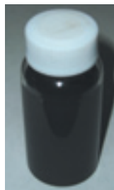
図10 加工中のホーニング液 Horning oil in horning machine
