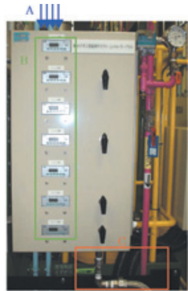
図2 ベースガス供給設備 (A: 純ガスボンベからの供給, 5B: マスフローコントローラ, C: ガスの混合部位) The feeder of base gas
