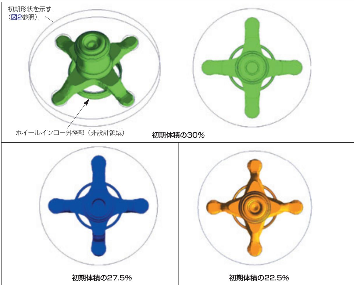
図3 トポロジー最適化解析結果
