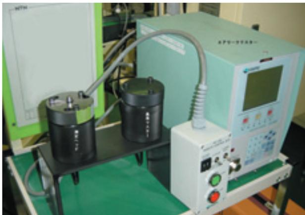
写真1 エア漏れ量測定器
