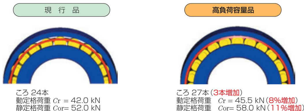
図2 設計例 (軸受サイズ:  $\phi 45 \times \phi 81 \times 16$ )
