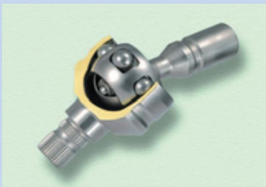
自動車のステアリング設計レイアウトの自由度を大幅に向上する、最大作動角48°まで使用可能な、軽量・コンパクトでガタのないステアリング専用等速ボールジョイントを開発した。
