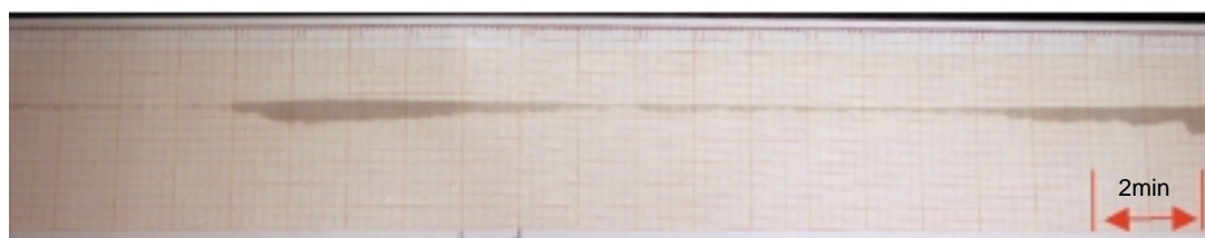
（c）ポリウレタンチューブ 2 x 4, エア量12.5NL/min, オイル量0.03mL/15min
