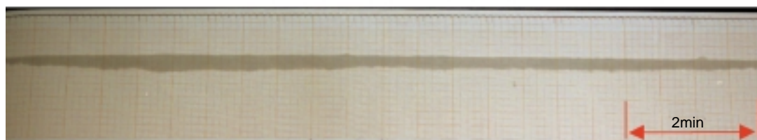
（b）テフロンチューブ 2 x 4, エア量12.5NL/min, オイル量0.03mL/5min
