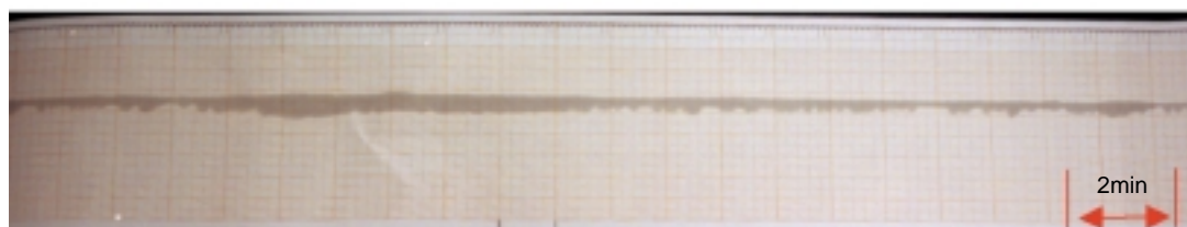
（d）ポリウレタンチューブ 2.5 x 4, エア量12.5NL/min, オイル量0.03mL/15min
