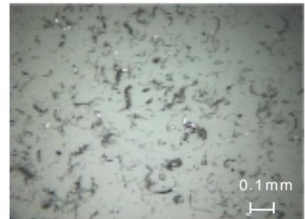
図3 研削屑の拡大写真
