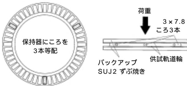
図6 静的強度の比較試験方法
