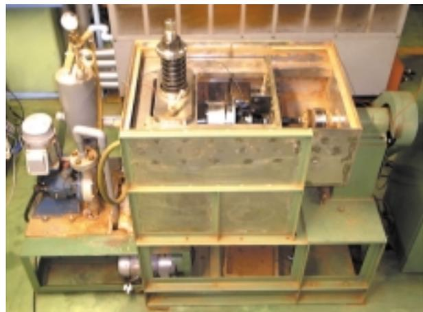
写真5 塩泥水耐久試験例
