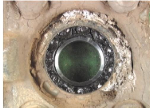
写真7 塩泥水耐久試験後外観 (GEN2)
