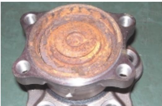
写真6 複合腐食試験後品 (GEN3)
