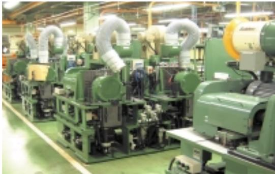
写真11 試験所の様子（H/B耐久試験機）
