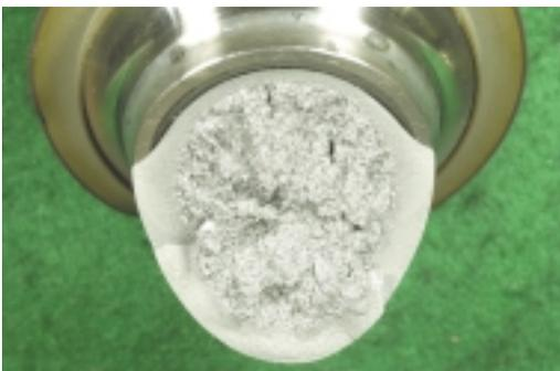
写真4 軸部の折損例 (GEN3)
