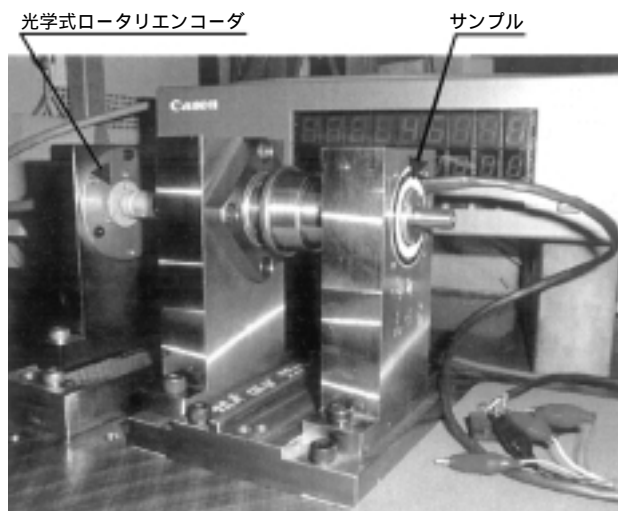
写真2 出力精度測定装置 Measurement system of output accuracy
