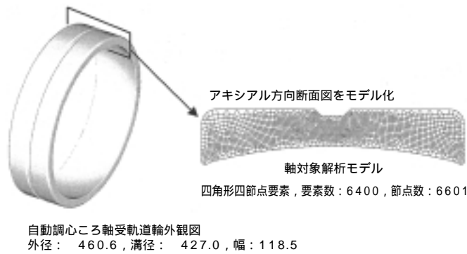
図15 自動調心ころ軸受外輪の解析モデル
