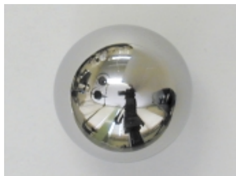
写真5 リテナ付きボールねじ992万ショット後のボール外観 Ball appearance after 9,920,000 shots with retainer
