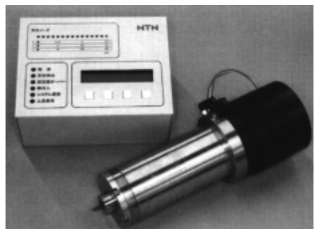
図13 マイクロエアドリル (Max120 000r/min) Air spindle for small hole drilling with the sensor box
