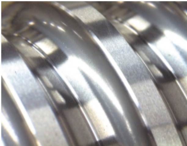
写真2 グリースBを100%初期封入した 40万ショット後の軸ねじ溝 The groove of the shaft after 400,000 shots
