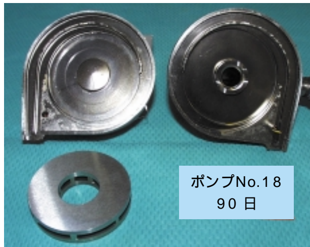
図6 90日経過後のポンプ内の様子 Disassembled pump after 90 days
