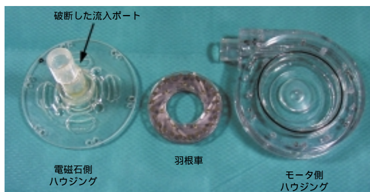
図5 864日後に破損したポリカーボネート製ポンプ部品 Disassembled T-ILVAS retrieved after 864 days due to fracture of the inlet port
