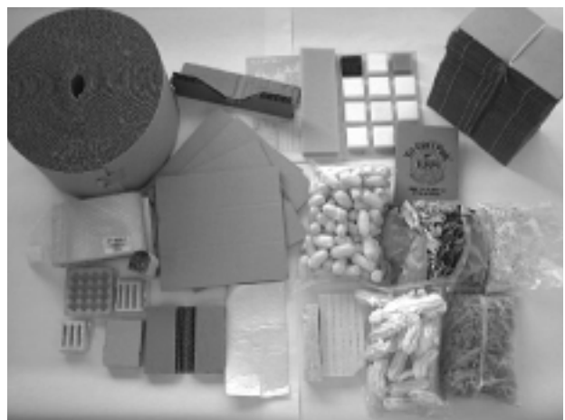
写真2 宝塚製作所で検討した代替緩衝材 Alternative material tested for shock absorption
