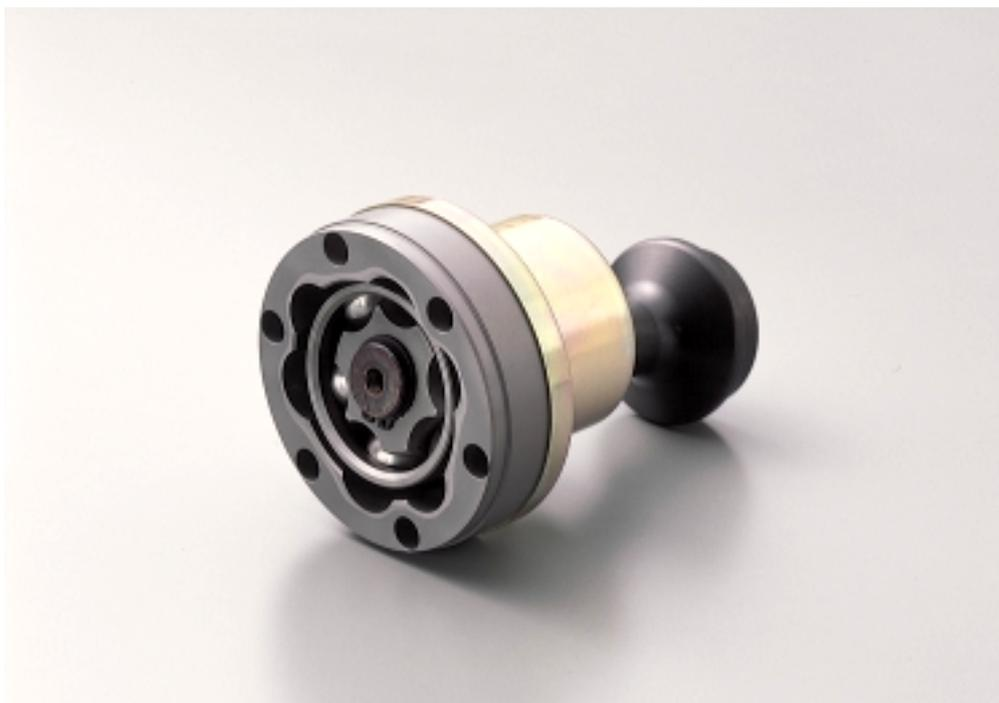
HLJ(High speed LJ)は、LJ(Cross Groove Joint)をベースにして、プロペラシャフト専用開発された高速性及び振動特性に優れた等速ジョイントです。
