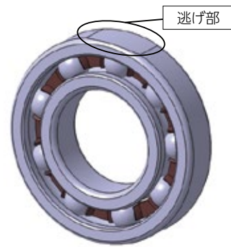
図9 「クリープレス軸受」の構造図 9)
