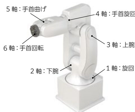
図 1 6 軸垂直多関節ロボット
