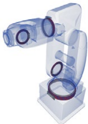
図 3 複列磁気エンコーダ付転がり軸受の適用可能部位
