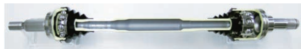
図12 リア用軽量ドライブシャフトの構造 (REBJ+中空シャフト+REDJ) Structure of light weight driveshaft for rear (REBJ + hollow shaft + REDJ)
