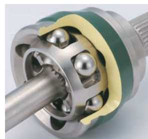
図7 BJの構造 Structure of BJ
