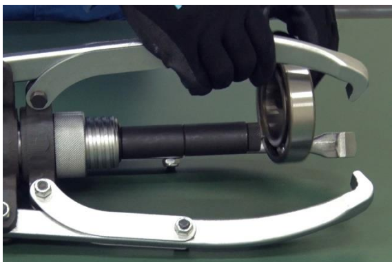
図 5.21 油圧引抜き治具から軸受の取除き(1)
