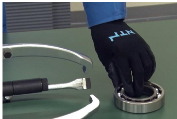
図 5.22 油圧引抜き治具から軸受の取除き(2)
