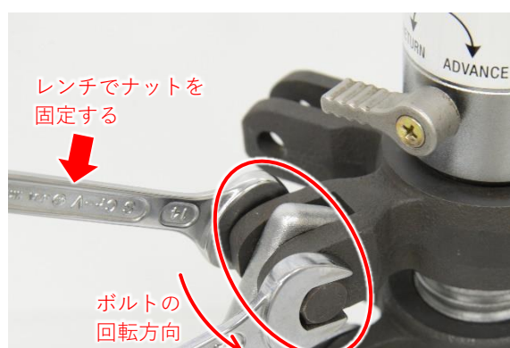
図 5.27 クロスヘッドからアームの取外し
