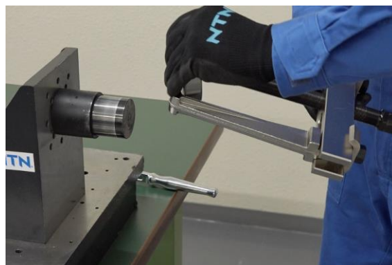
図 5.38 引抜き治具の取付け(6)
