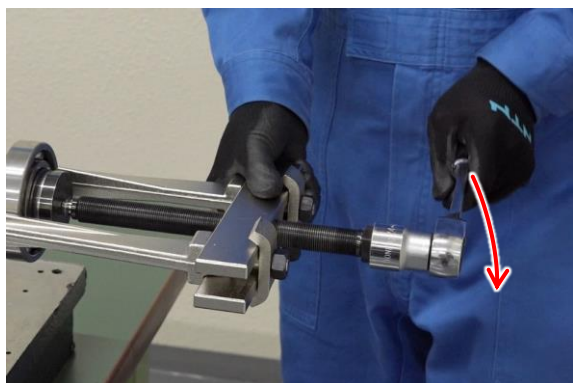
図 5.37 引抜き治具の取付け(5)
