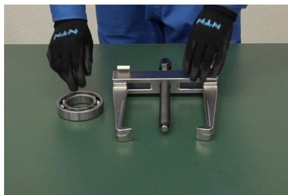
図 5.40 引抜き治具の取付け(8)
