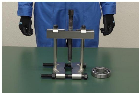
図 5.22 軸受の取外し(4)
