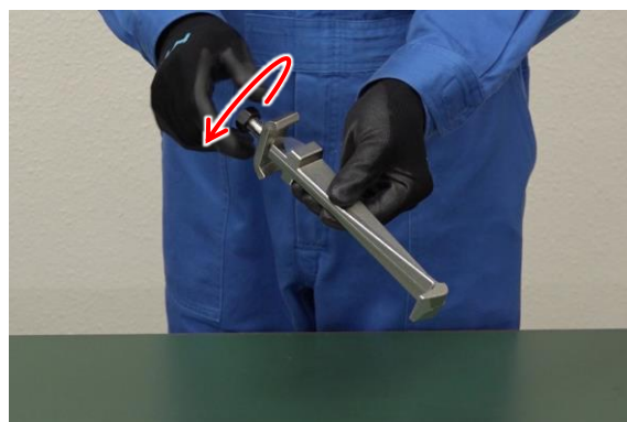
図 5.29 ナットの取付け
