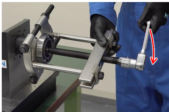
図 5.19 軸受の取外し(1)
