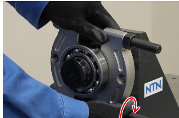
図 5.4 分離プレートのナットの締付け
