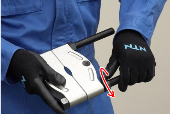
図 5.1 分離プレートのナットの緩め
