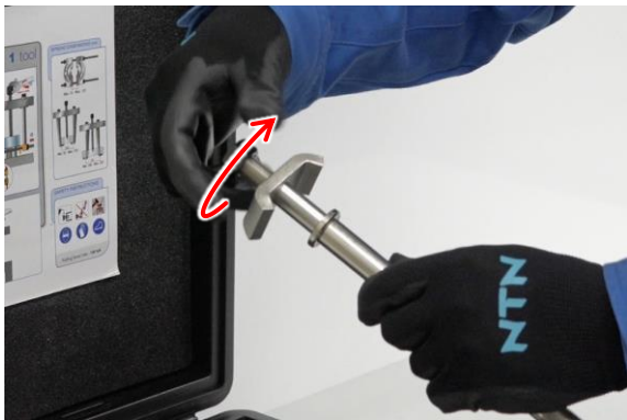
図 5.25 ロッドのナットの取外し
