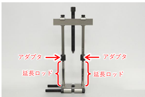
図 5.15 延長ロッドを使用する場合
