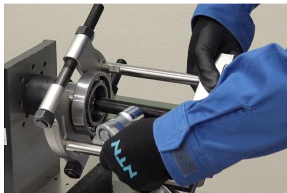
図 5.20 軸受の取外し(2)
