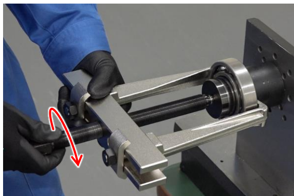
図 5.35 引抜き治具の取付け(3)
