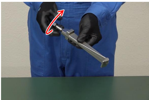
図 5.27 アームのナットの取外し
