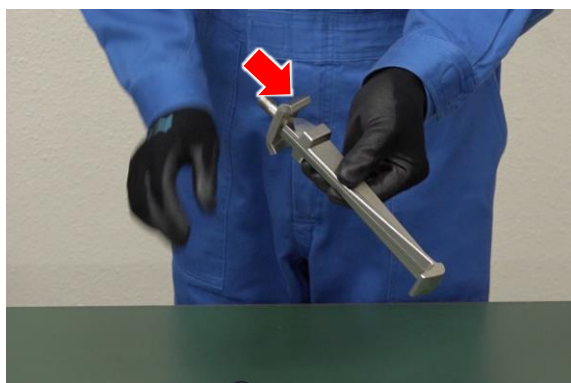
図 5.28 フランジの取付け
