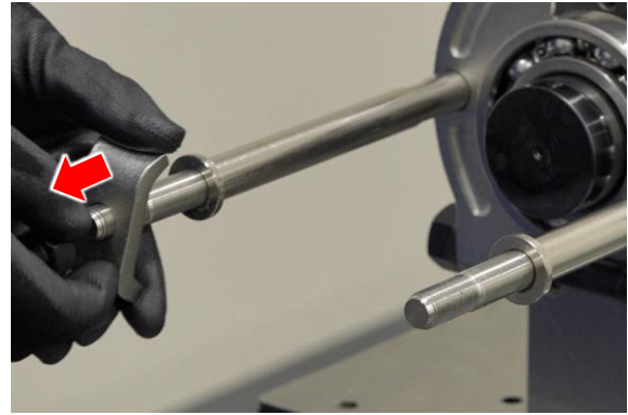
図 5.10 フランジの取外し
