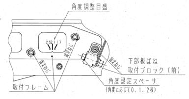
⑥前後の下部板ばね取付ブロックの角度設定スペーサを、組付け角度に応じて次表の枚数に 組付けする。
