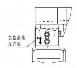
(2) 搬送するワークによって、本体の調整を行なってもリターントラフの登坂性能が確保できない場合は、市販のベルト材を送路面に接着してください。
