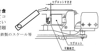
② 全く吸引されない場合……コントローラ、マグネットを含む電気系統の故障です。但し、センサ付コントローラの場合には、検出ヘッドがワークを検出している状態が考えられますので、ワークを取り除いてください。また、センサが誤検出している場合には、光軸合わせ、近接距離等の再確認をして下さい。
