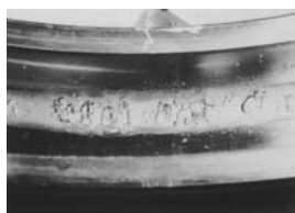
フレーキング (剥離)
