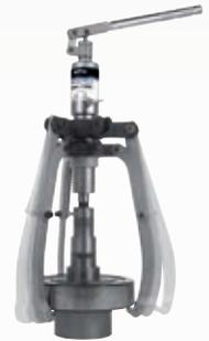
※引抜き時に軸受が破損し、飛散して人や周囲の機械を傷付ける可能性があるため、付属の保護カバーで覆ってから油圧を掛けてください。
