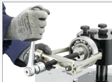
2アーム引抜き治具を用いた引抜き
