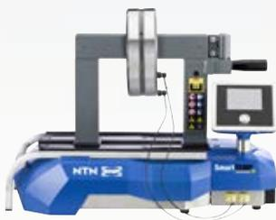
ピボットヨークを備えた誘導加熱装置、メンテナンスまたは生産現場向けのベストセラーで、最大重量100kgまでの軸受を加熱することができます。
