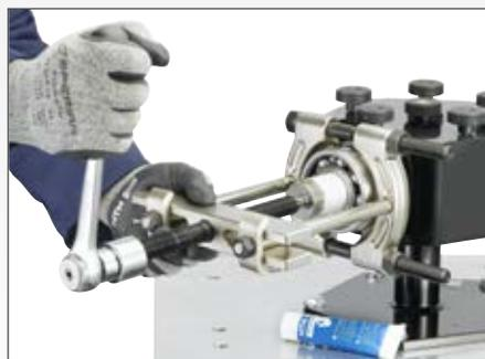
背面引抜き治具を用いた引抜き
