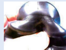
オゾン劣化による亀裂発生
