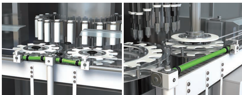
食品機械 使用箇所: 洗びん機のスクリュー駆動部 使用箇所: 打栓機のスクリュー駆動部
