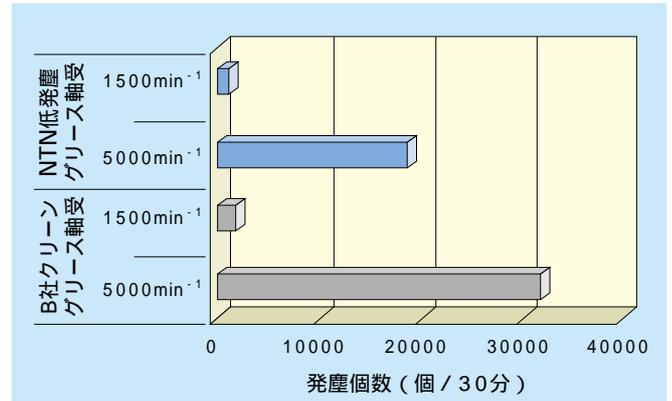
図10 低発塵グリース封入軸受発塵測定例 (大気)
