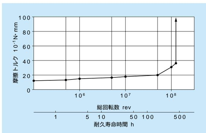
図4 Ag IP軸受の耐久評価例
