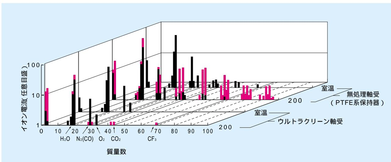
図18 室温時と高温時のアウトガス比較測定例
