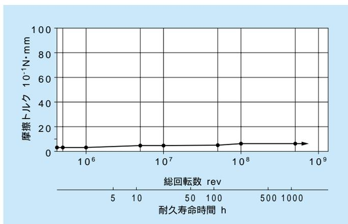
図5 Pb IP軸受の耐久評価例
