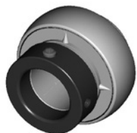
一方方向回転に対しての軸の固定力が要求される箇所 偏心カラー方式
