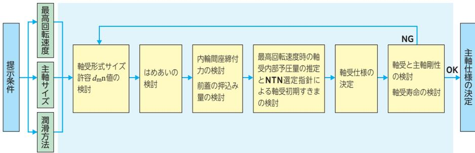
工作機械主軸用軸受の場合、選定に際し、基本検討を行うために必要な項目を表 2.3 に示します。
