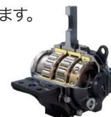
0系新幹線車軸軸受と軸箱カットモデル
