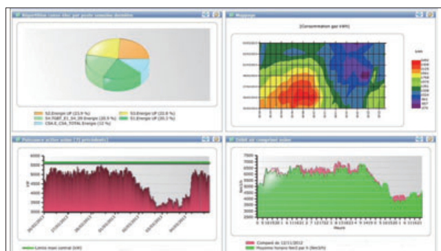
観測装置の画面上に表示された電力・ガス・圧縮空気などの使用状況
