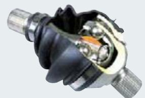
NTNでは、日本で初めて1963年に固定タイプの等速ジョイントを世に送り出しました。その後DOJやTJなどしゅう動タイプの等速ジョイントを取り揃え、シャフトに固定タイプとしゅう動タイプの等速ジョイントを取り付けたドライブシャフトとして、FF車を生産する自動車メーカーに提供してきました。
