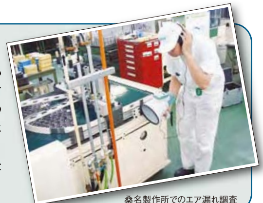
桑名製作所でのエア漏れ調査
