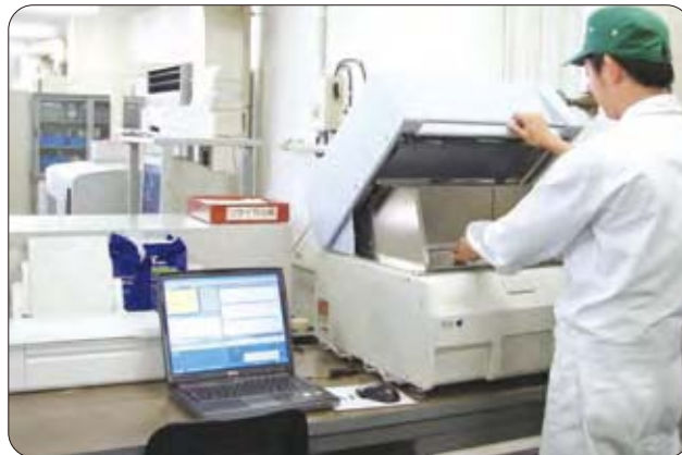
けい光X線分析器を用いた受入検査
