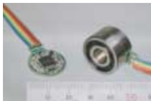
磁気アレイ式回転センサ(左) 磁気アレイ式回転センサ付玉軸受(右)
