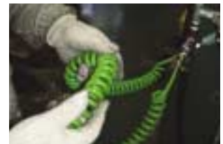
エア漏れの点検
