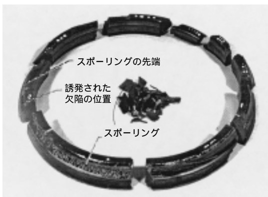
図13 dn 値300万で運転された120mm内径アンギュラ玉軸受の破壊した内輪レース。誘発欠陥の位置で内輪のスポーリングが原因である。 Fractured inner race of 120mm-bore, angular ball bearing operating at 3 million DN caused by inner-race spalling at induced defect.
