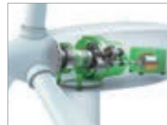
主軸、増速機、発電機等の回転を支える
